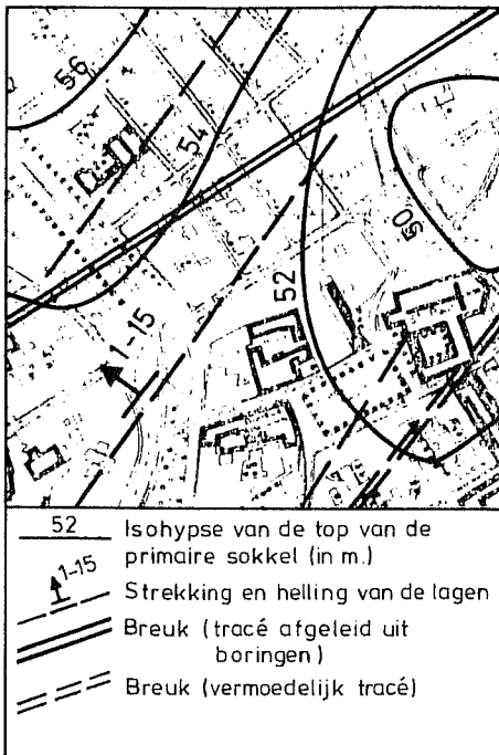
6. Uittreksel van een isohypsenkaart (Grondmechanische kaart 42.2.7 Luik).
